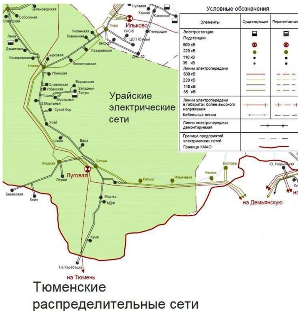
Рисунок 2. Схема электроснабжения Урайского энергорайона
