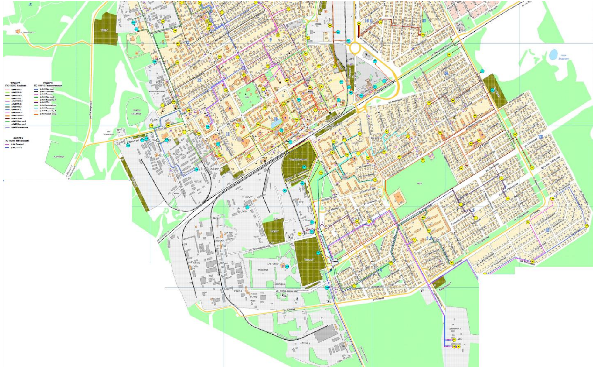
Рисунок 6. Карта (схема) сетей электроснабжения муниципального образования город Югорск (часть 2) Источник: АО «ЮРЭСК»
