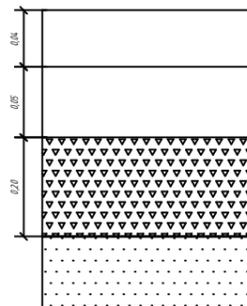
Асфальтобетон плотный из горячей мелкозернистой щебеночной смеси тип В марки I на битуме 90/130
